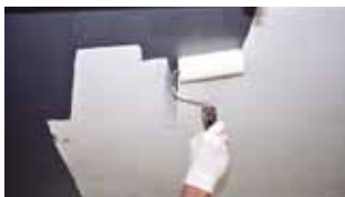
Nanesite antifauling povrhu temelja ili izolacijskog premaza.
