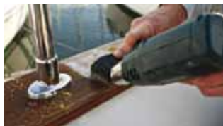
Odstranite stari lak sa pištoljem s toplim zrakom
