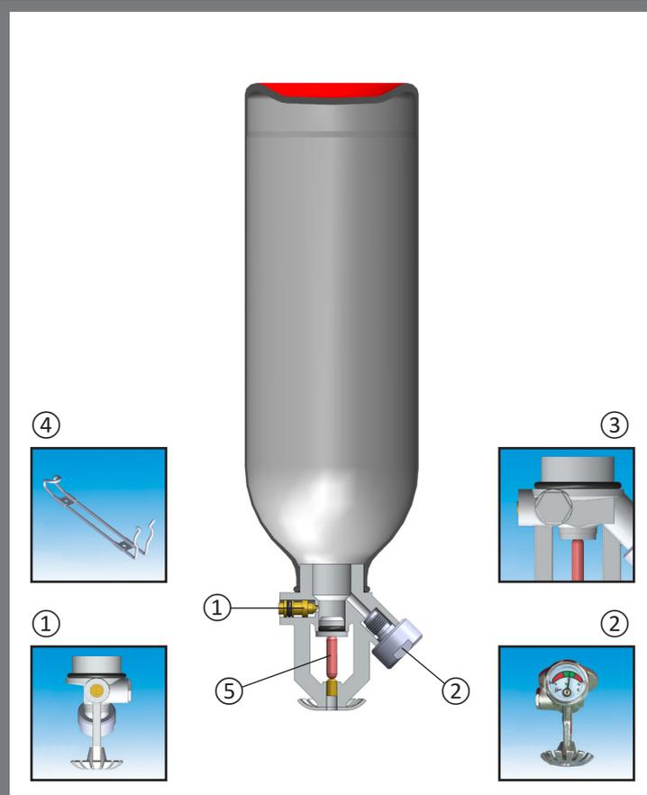
① Otturatore per pressurizzazione e rilascio pressione regolabile durante le manutenzioni.
