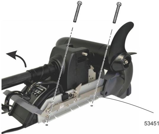
9. Aligner le moteur de pêche à la traîne avec les trous de montage du pont. Maintenir fermement les boulons de fixation avec une clé de 11 mm tout en utilisant une clé ou une douille pour serrer les écrous Nylock des deux côtés du support de montage sur pont, depuis le dessous du pont.
