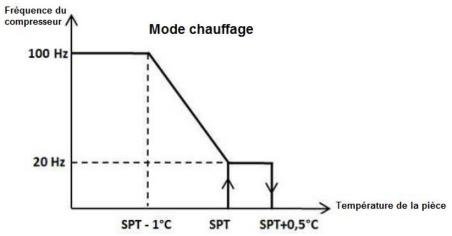
SPT = Set Point Temperature = Température de consigne Température de la pièce > SPT+0,5°C ⇒ Fin du cycle de chauffage Température de la pièce > SPT-1°C ⇒ Baisse de la fréquence
