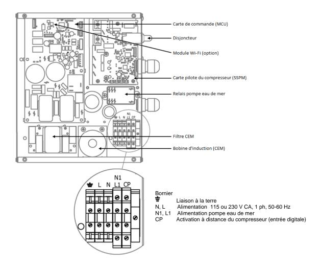
**CP**: contact pour l'activation à distance du compresseur. Lorsque le contact est fermé, la climatisation fonctionne normalement et peut être commandée via le thermostat ou la télécommande. Lorsque le contact est ouvert, la climatisation bascule en mode stand-by et ne peut pas être activée via le thermostat ou la télécommande. Dans ce cas de figure, l'afficheur indique « SB ».
