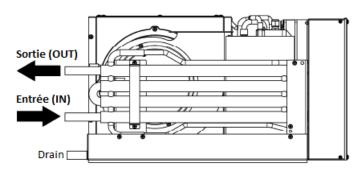
**NB**: pour permettre les interventions d'entretien ou de maintenance, il est essentiel que chaque connexion hydraulique soit munie d'une vanne d'isolement.
