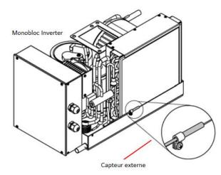
En cas de défaillance du capteur de température, le système est stoppé et le code d'alarme E1 est affiché sur le panneau. Remplacer le capteur défectueux et/ou sélectionner l'autre capteur. Si le capteur est à nouveau sélectionné alors qu'il n'a pas été remplacé, le code d'alarme s'affichera à nouveau.
