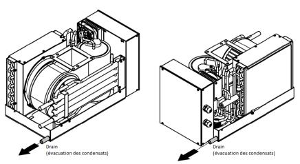
Les condensats produits par le système doivent être évacués en fond de cale II est préférable d'évacuer les condensats vers une pompe de relevage, pour ne pas risquer d'aspirer les gaz d'échappement produits par l'unité elle-même et par le(s) moteur(s) de propulsion.
