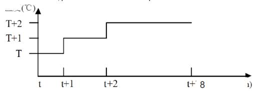
Si le mode nuit est activé en mode chauffage, la température de consigne est automatiquement diminuée de 2°C au bout d'une heure. À l'issue de la seconde heure, elle est à nouveau diminuée de 2°C (diminution de 4°C sur deux heures). Elle est maintenue durant les 6 heures suivantes, puis la climatisation s'arrête après 8 heures de fonctionnement en mode nuit.
