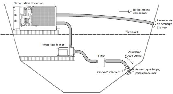
Diamètre minimum des tuyauteries eau de mer : 16 mm (1/2").
